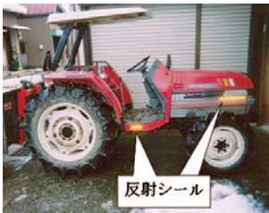
乗用トラクター側面に貼り付けた反射テープ
